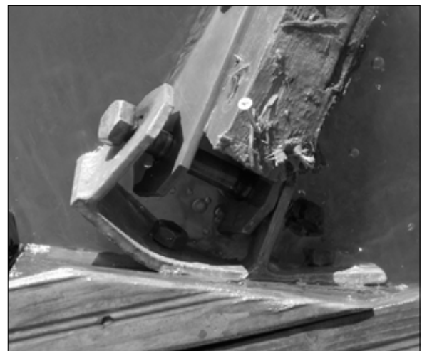
Kiinnityksen taivuttamiseen tarvitaan voimaa... tämä on 10mm terästä.
